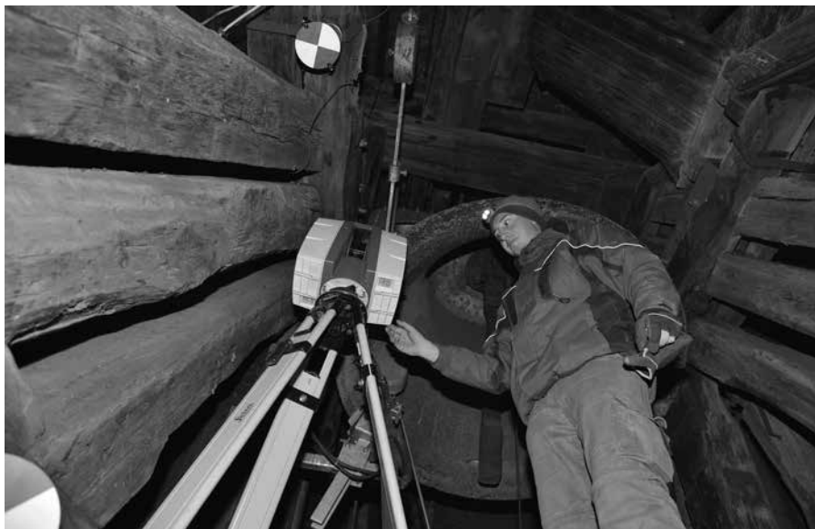
Před zpracováním architektonických návrhů prošla věž podrobným zmapováním pomocí speciálního 3D skeneru (foto J. Preclík)
