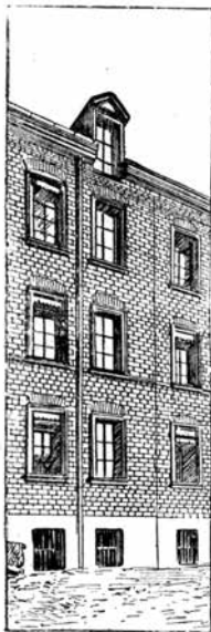
Scherrerova záchranná okna uzavřená.
